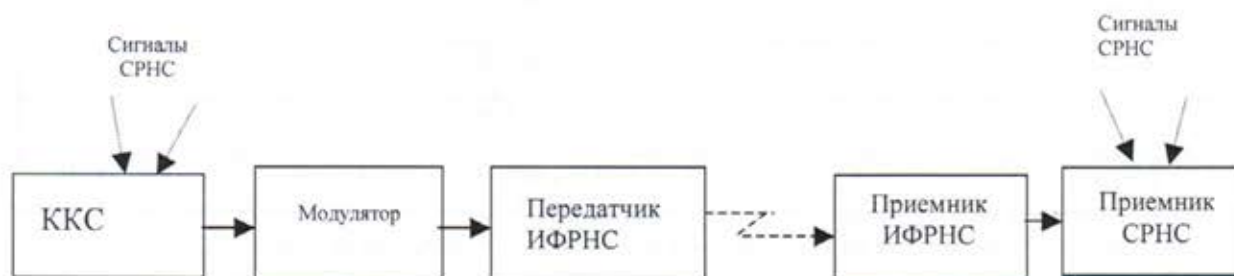
Рис. 1. Обобщенная структурная схема РДПС на основе ИФРНС
